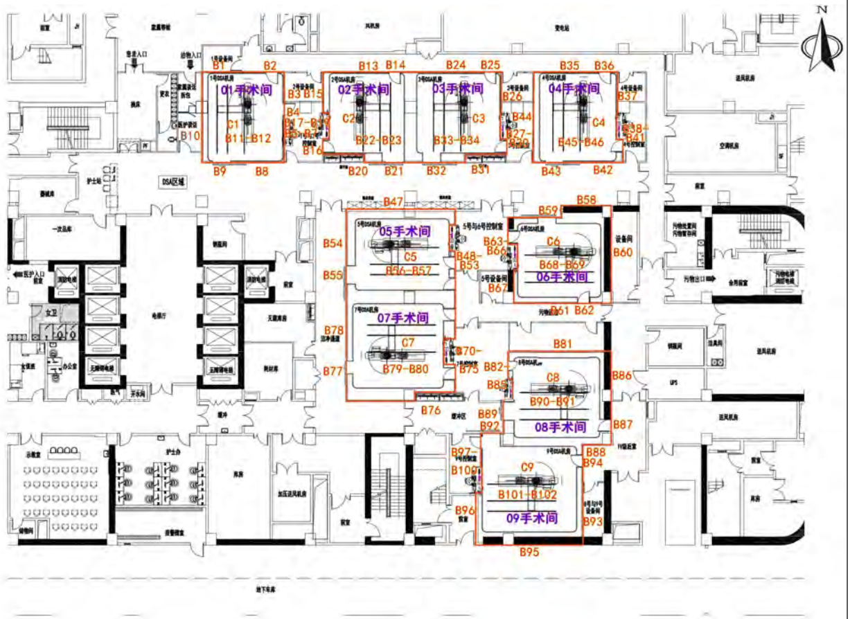
图 6-3 开机状态下介入中心各手术间周围监测布点图
